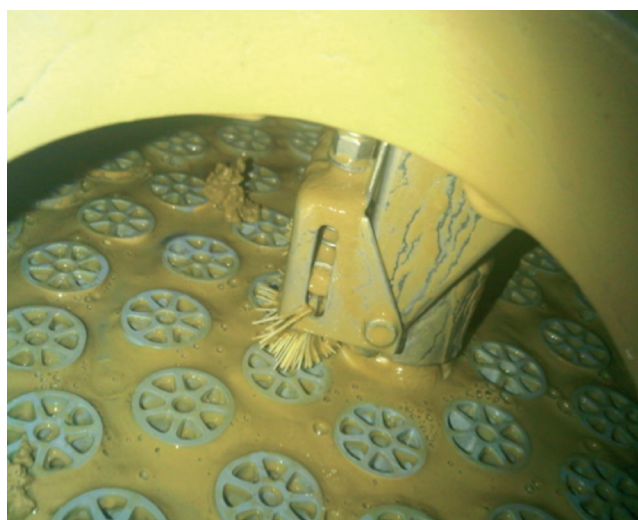
5. ábra. Membrántisztító egység műanyagkefés rendszere
