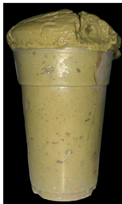
3. ábra. A kerámiaszűrő és rosta (előszűrő) által visszatartott szűrlet konzisztenciája
