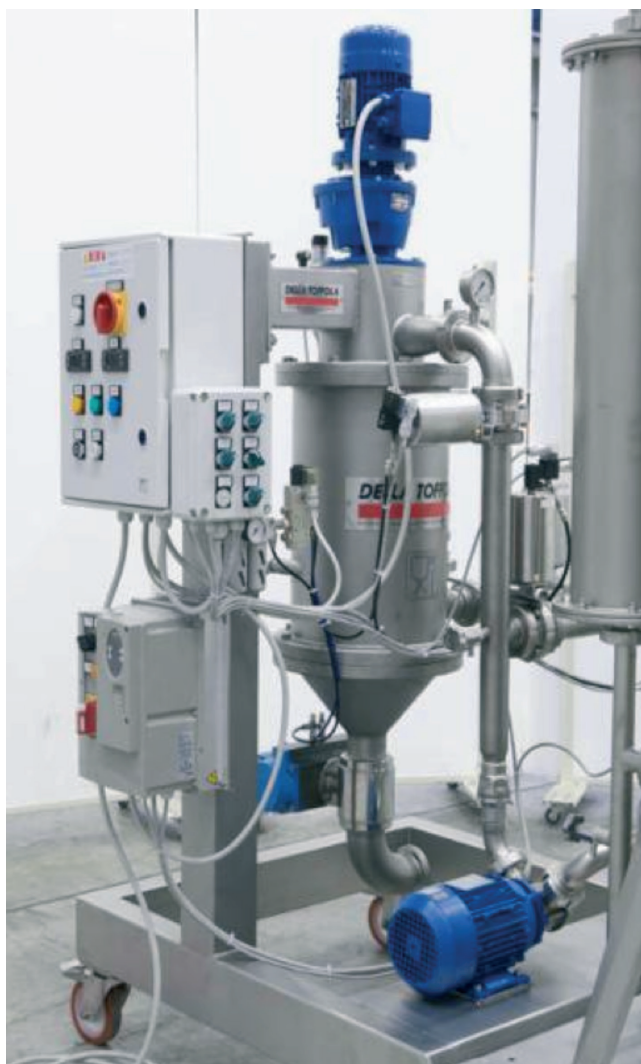
4. ábra. A vertikális rotációs szita (rosta) – előszűrő
